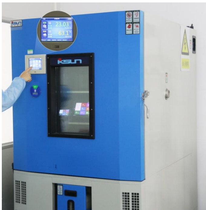
图 7-3 高低温老化测试图
