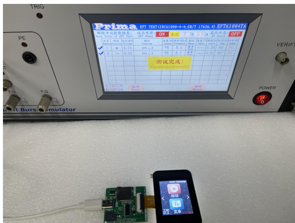
图 7-4 群脉冲测试图
